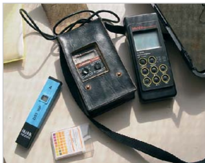
Material de lectura rápida de conductividad y pH. Son imprescindibles para que el invernadero realice las comprobaciones diarias de la solución nutritiva y de drenaje
