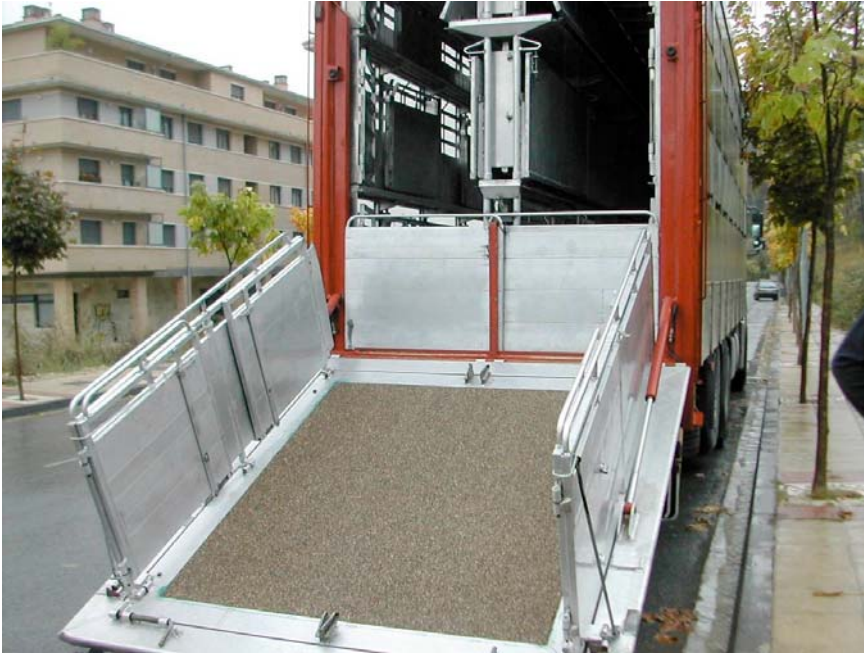
Foto: Ascensor con barreras de seguridad y suelo antideslizante.
