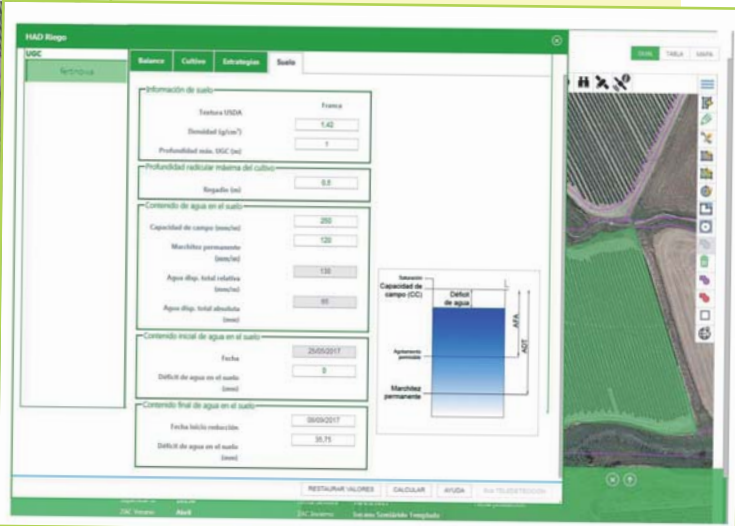
Figura 6. HAD RIEGO. Interfaz para modificar los parámetros asociados a las características del suelo de la parcela.
