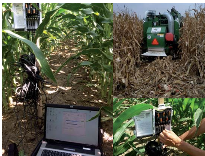
Sensores de humedad en suelo para evaluación de necesidades de riego en los cultivos y cosecha de las parcelas de ensayo.
